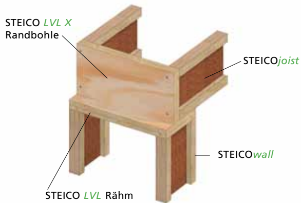
F1 Deckenanschluss mit Randbohle
