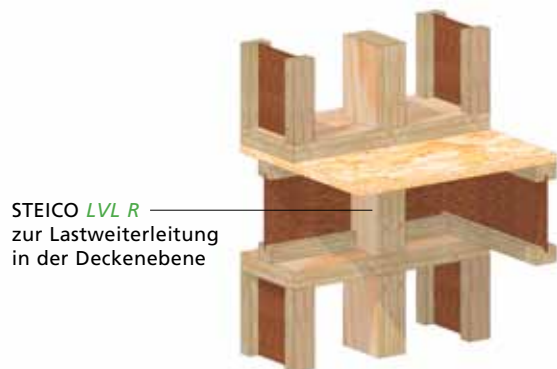
F5 Weiterleitung hoher Einzellasten durch die Deckenebene
